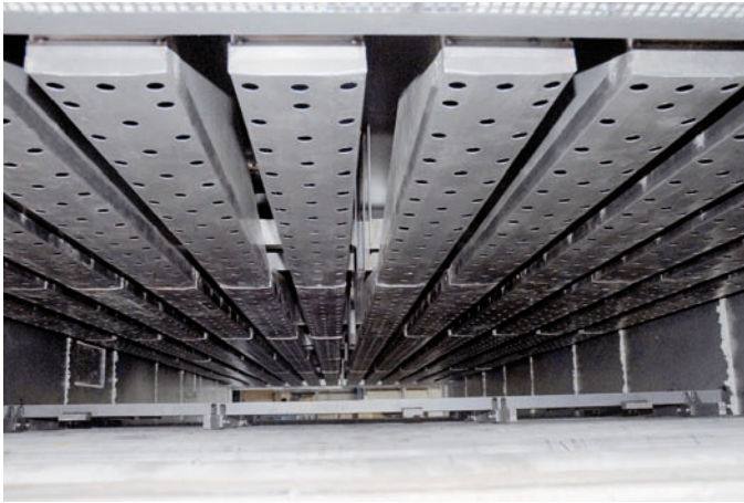
Bild 7: Düsenfeld für Prallströmung (Quelle BSN) Fig. 7: Nozzle array for impingement flow
