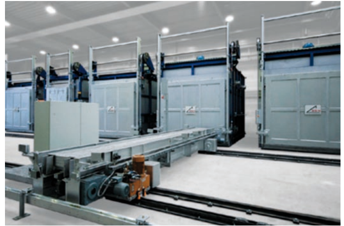
Bild 8: „Jet-Heating“-Kammerofenanlage für Aluminiumbauteile (Quelle BSN)
